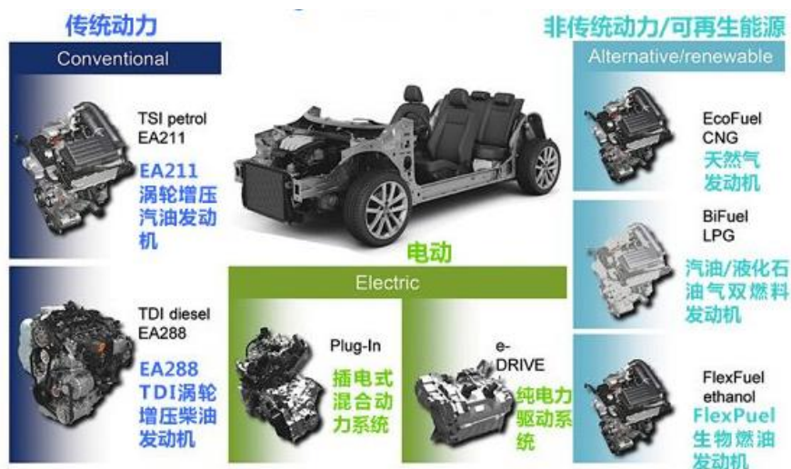
图3 大众MQB平台的动力总成
